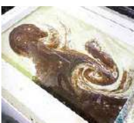
洗浄前の工作機械の切削液
