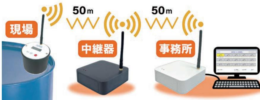
1台で通信距離を50m、最大5台使用で250m延長できる。遠隔モニタリングシステムは、オイル、灯・軽油、アドブルーなどの残量「%・リットル」を液晶パネル上に表示、記録が可能で、最適な補充タイミングを見極めるなど液体管理効率化を後押しする。
